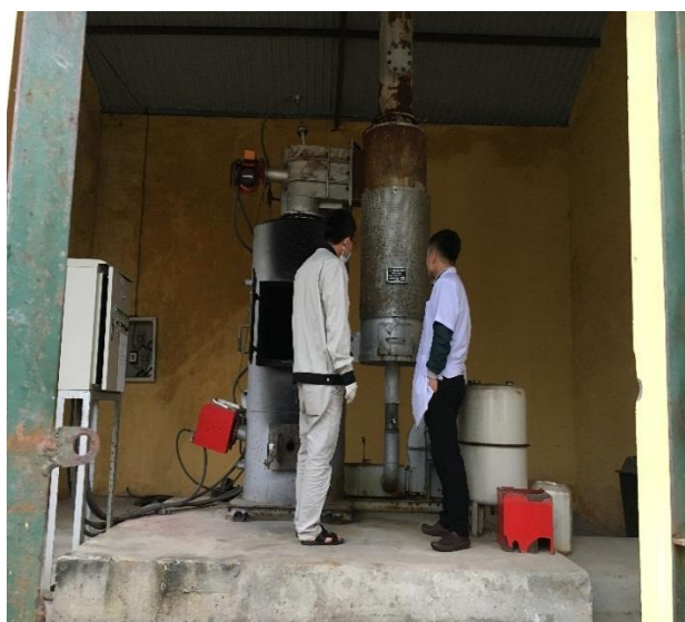
Hình 3.21. Lò đốt Chuwastar và hệ thống nghiền cắt khử khuẩn
